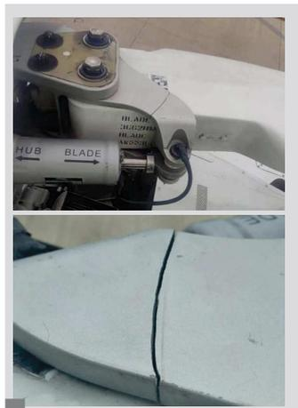
**FALHA GRAVE** Componente quebrado
